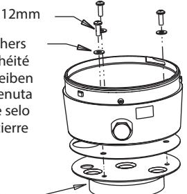
If using conduit, assemble conduit hub to conduit first, then attach to base.
